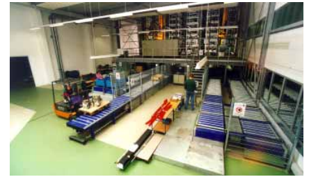
Vorzone am Palettenlager mit 3 Kommissionierarbeitsplätzen und Ganzauslagerstrecke
