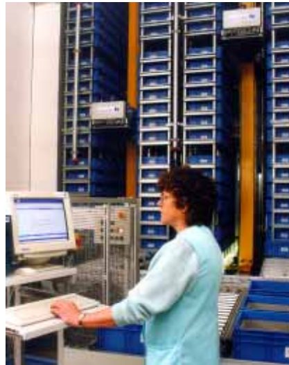
AKL-Vorzone mit Kommissionierarbeitsplatz und Fördertechnik
